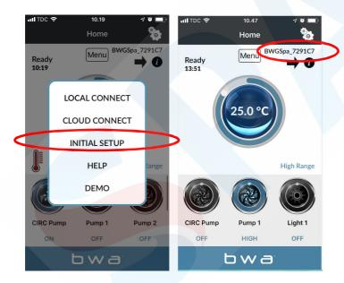
La deuxième étape consiste à connecter votre module wifi à votre routeur wifi local dans les paramètres de l'application bwa via l'icône des paramètres. Il doit être de 2,4 GHz et non de 5 GHz. Vous devez rester près de votre spa et disposer d'un bon réseau wifi. Entrez le nom du réseau et le mot de passe et appuyez ci-dessous. En standard, la configuration est définie sur WPA. Vous devrez peut-être choisir WEP; WPS; OPEN, selon votre routeur.
